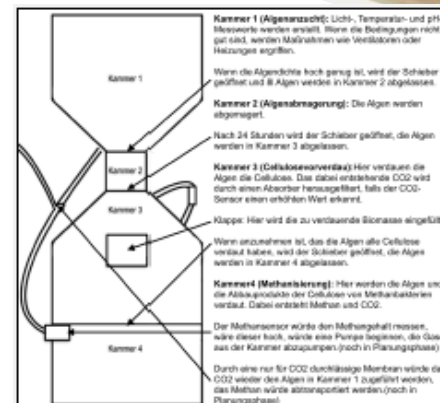
Abb. 1: Schematischer Aufbau der mehrstufigen Modell-Biogasanlage
