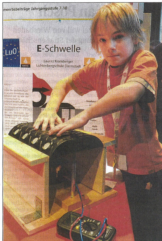
Mit voller Kraft drückt Lauritz Kramberger das von ihm konstruierte Modell einer Fahrbahnschwelle herunter, die bei der Überfahrt von Autos elektrische Energie erzeugt.
