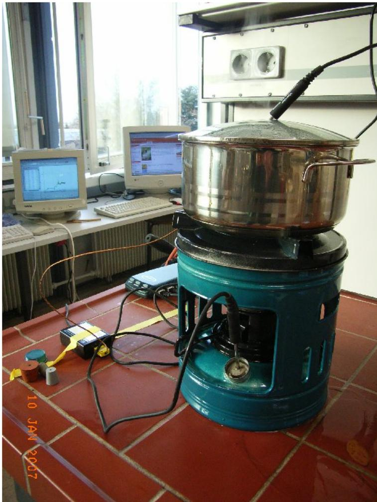
**Die Messapparatur mit Thermofühlern, Topf und Interface**
