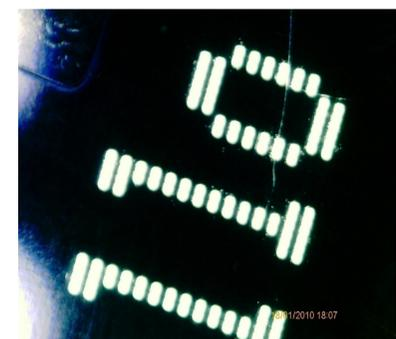
Abb. 5: Pixel Nahaufnahme des beigelegten OLED- Moduls
