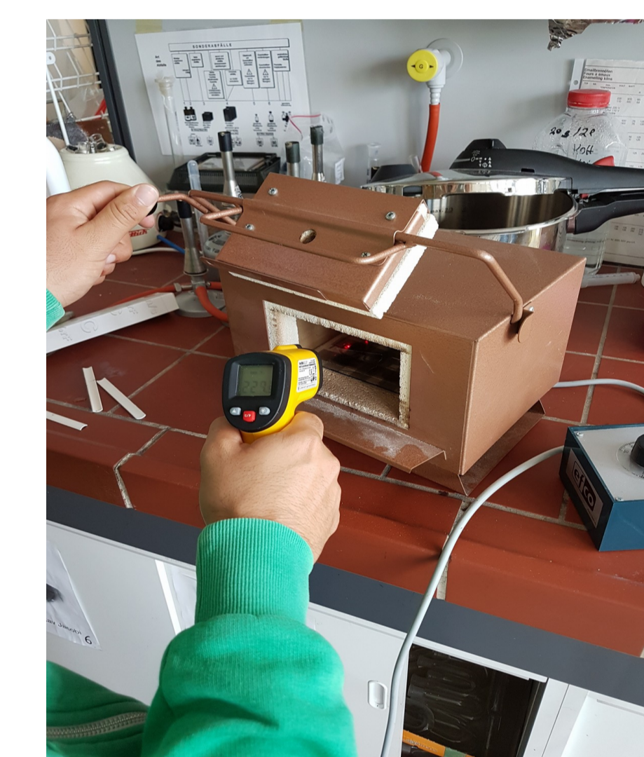
Fig. 6 Die Glasplatten werden in einem Ofen erhitzt, damit die Indium-Zinn-Beschichtung mit dem Sauerstoff reagiert.
