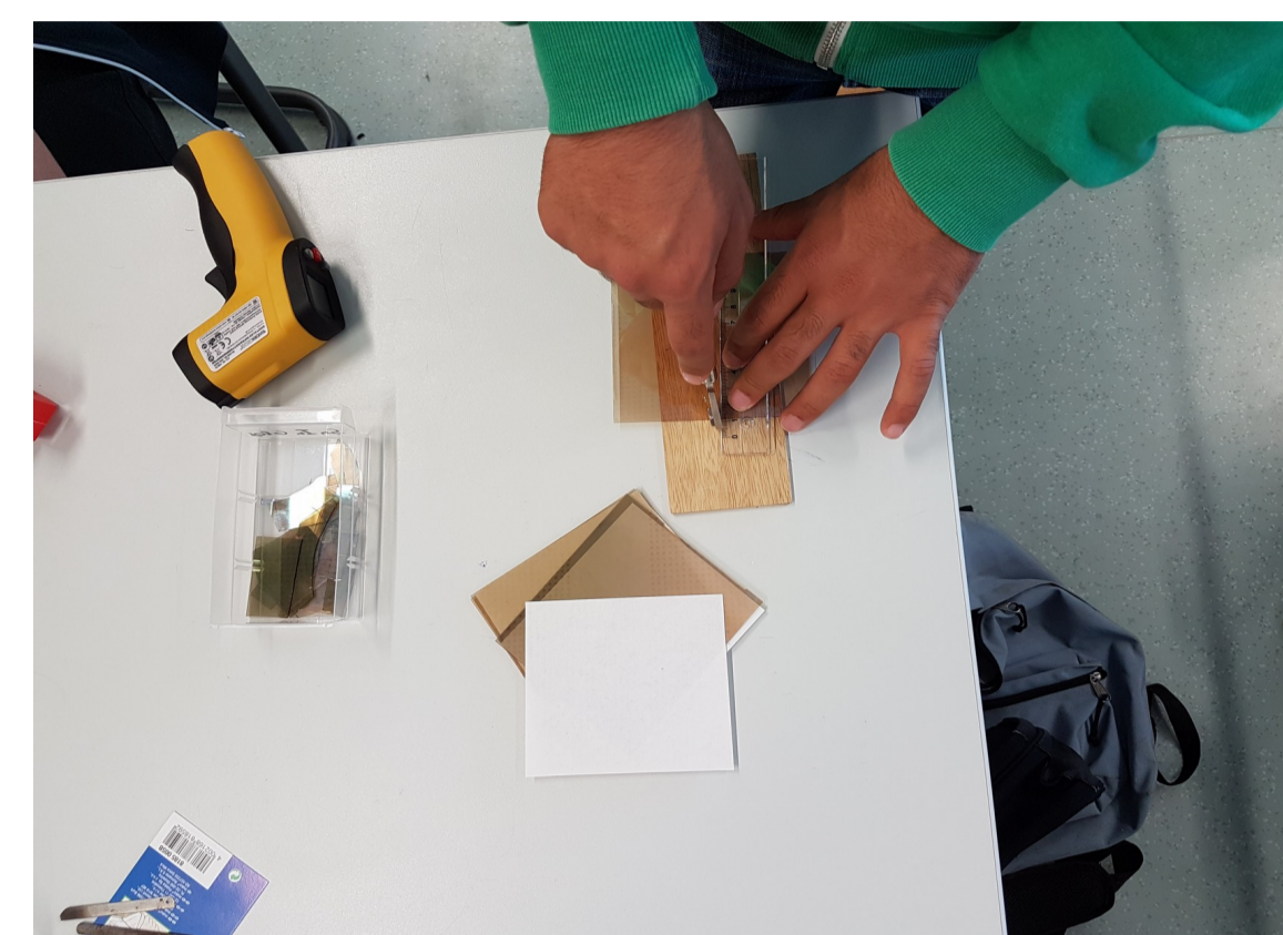
Fig. 3 Hier werden die beschichteten Glasplatten mit einem Glasschneider geschnitten
