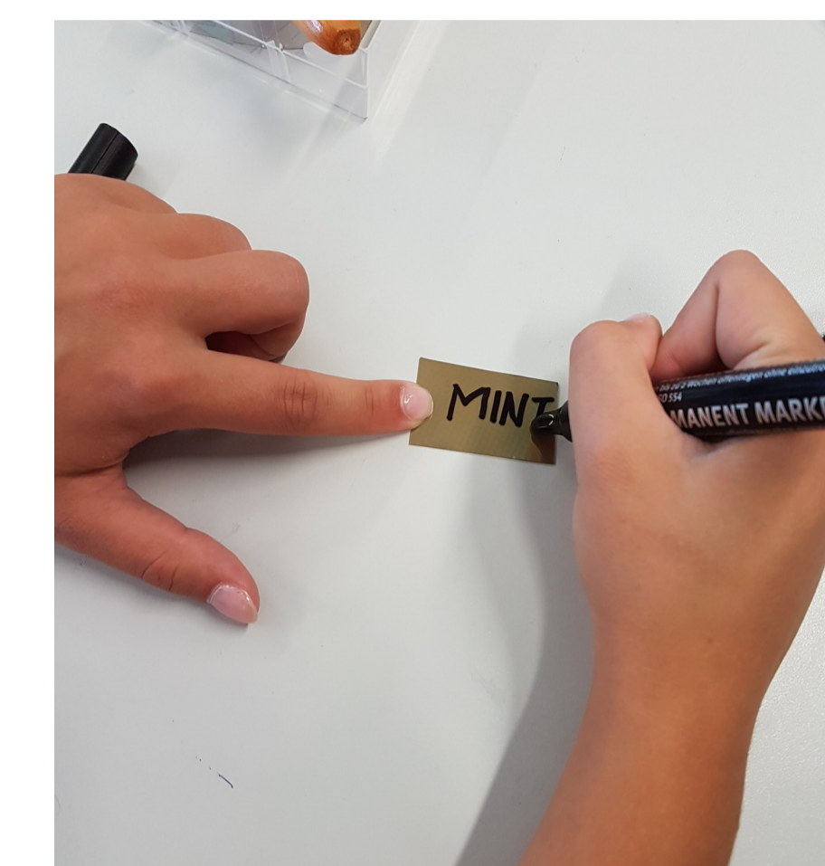
Fig.4 Die Struktur, die später die Elektroden haben werden, wird hier mit einem wasserfesten Stift vorgezeichnet. Diese bleibt nach dem ätzenden Bad zurück.
